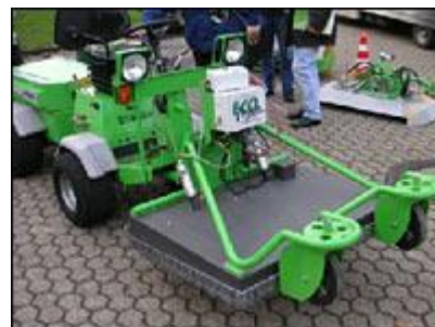
Die Unkrauterhitzer von ECOflame arbeiten mit der Infrarottechnik
